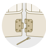
Fissazione del sommier alla testiera con perno
