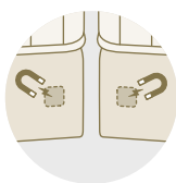
Fissazione del sommier alla testiera con magneti
